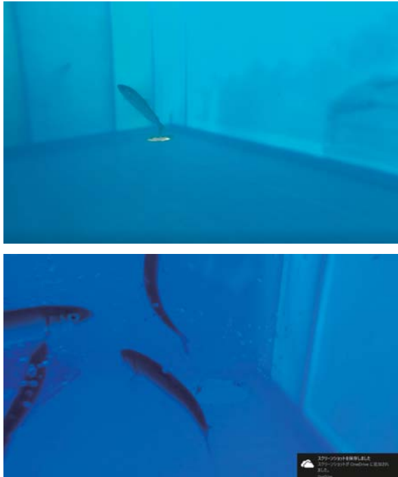
図8 コンテナボックス内に設置したビデオのスナップ写真。上:7段積みの1段目で簡易魚道内に入ってきたアユ。下:7段積みの3段目で簡易魚道内を往来するアユ
