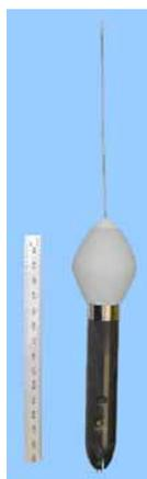
PAT(写真:左)は、放流魚を再捕獲しなくともデータを回収できる最新型の標識です。鉗で背中に打ち込み固定します。3つのセンサーを搭載し、水深(0~1000m)、水温(-40~60)、光レベル(水深300mでも日出と日没時刻を正確に判別可能)を記録します。内蔵されたタイマーにより設定時間が経過すると、自動的に魚体から切離され、海面に浮上します。浮上したPATからは、アルゴスシステム<sup>1)</sup>を通じ、人工衛星経由で装着されていた期間のメカジキの遊泳データが送信されてきます。このデータをインターネット経由
