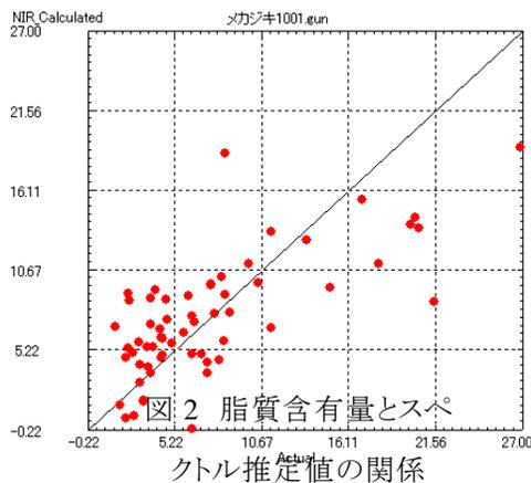
近赤外分光分析器でメカジキの脂質含有量を測定するための関係式は、図2とおりのです。今後、本器を用いて、水揚げ時に脂肪含有量を推定することが
