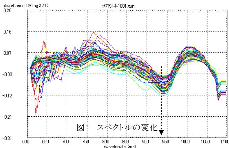
図1は、吸光度1次微分スペクトルですが、どのサンプルも 940nm 付近(矢印点線部分)で強い吸収が行われたことがわかります。
