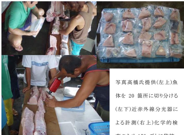
写真高橋氏提供(左上)魚体を20箇所に分ける(左下)近赤外線分光器による計測(右上)化学的検査のため150gごとに袋詰
