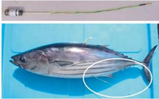
図1 電子標識(上)と電子標識(丸印内)を装着したカツオ(下)
