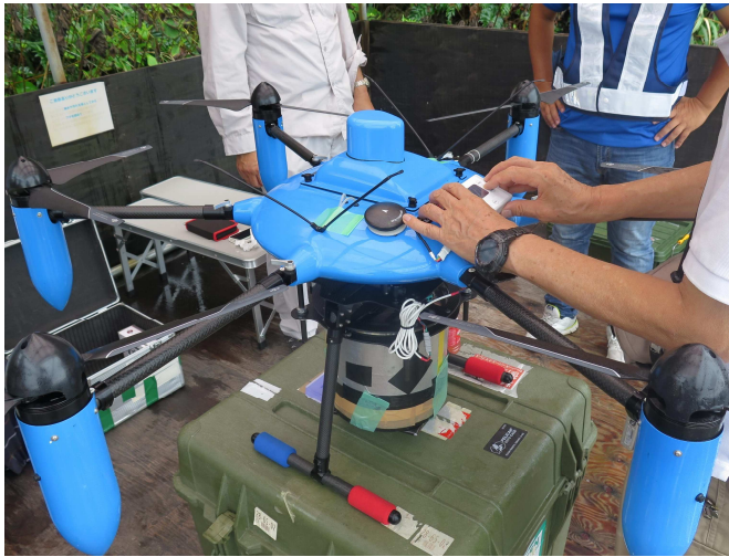
図1 大型ドローンの下部に搭載したハイパースペクトルセンサー（空中重量は約5kg）
