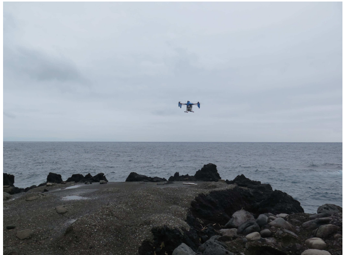
図2 観測中のハイパースペクトルセンサー搭載ドローン（予め設定したコースに沿って飛行）
