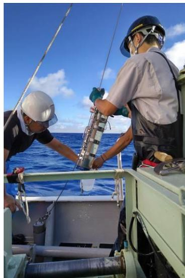
写真1：バンドン式採水器による採水
